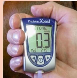
*L'appareil sert à déterminer la concentration en BHB dans le sang.*
